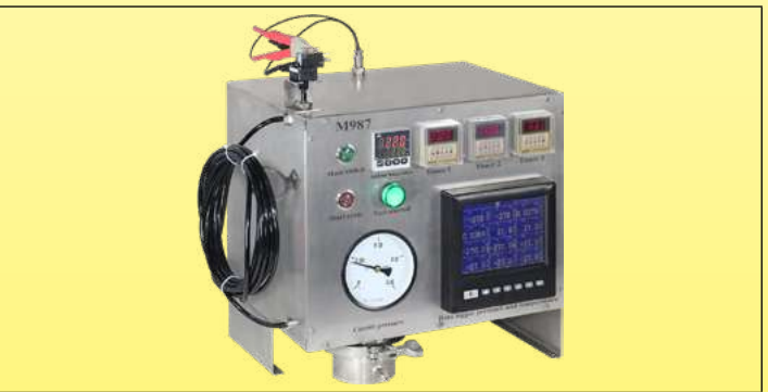
Prüfgerät zur wiederholten und konstanten Messung der maximalen Länge der Verbindungsschläuche der Luftschalter in Abhängigkeit vom Volumen des Drucktasters und dem von ihm entwickelten Druck (Ultimheat Labor)
